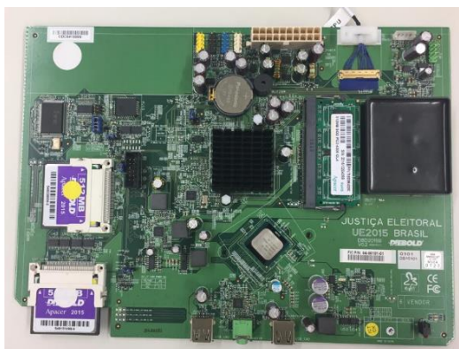
Imagem: placa-mãe da urna eletrônica (Fonte: TSE)
